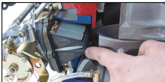
Soupapes à clapets que l'on retrouve dans la Fusion 900.
