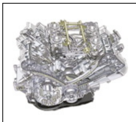
Moteur V-4 90 degrés de la moto Honda VFR 800.
