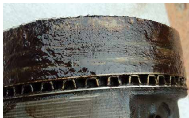
Voici un piston avec les segments saisis, le résultat de dispersants et de détersifs de l'huile à moteur qui n'ont pas fait leur travail.
