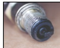
Bougie encrassée (gauche) versus bougie en bon état (droite)
