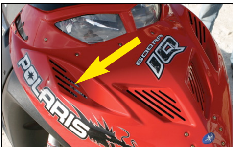
Le capot de la 600 RR possède une conduite d'air prévue pour refroidir le système de freinage.
