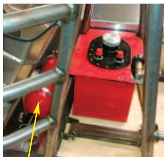
L'extincteur, en place derrière le siège, est facile d'accès.
